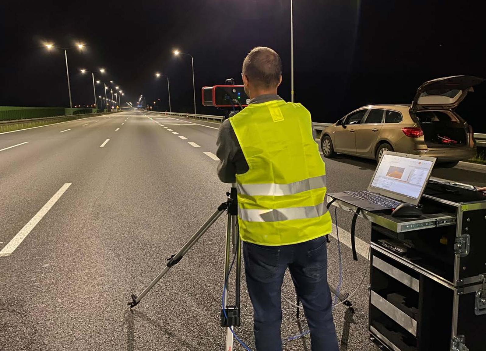
*Abbildung 1: Eine richtig gestaltete Straßenbeleuchtung erhöht die Sicherheit von Fahrern und Fußgängern auf der Straße. Daher ist eine Messung der Leuchtdichteverteilung ein wichtiges Werkzeug.*
